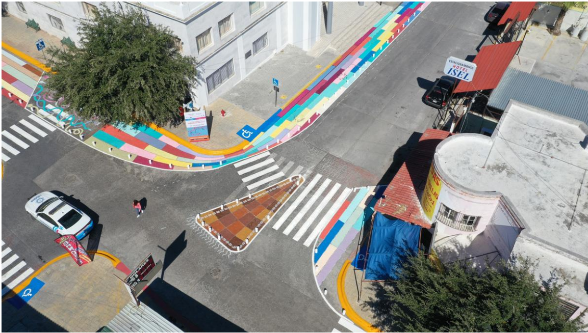
Imagen No. 10. Pintura de una isleta que facilita el cruce de personas y obliga a los autos a bajar la velocidad, reduciendo así el riesgo de accidentes. Fuente: Urbanismo táctico- ONU-Habitat. https://onuhabitat.org.mx/index.php/urbanismo-tactico-elemento-clave-en-la-recuperacion-post-
