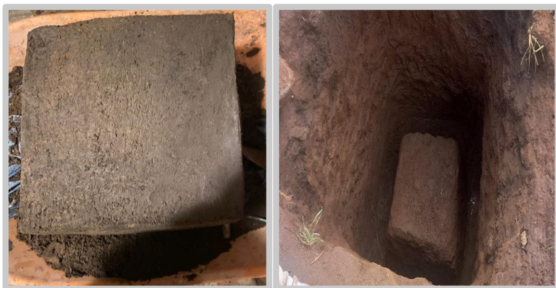
Figura 3. Fotografía de la extracción de muestra de una calicata.
