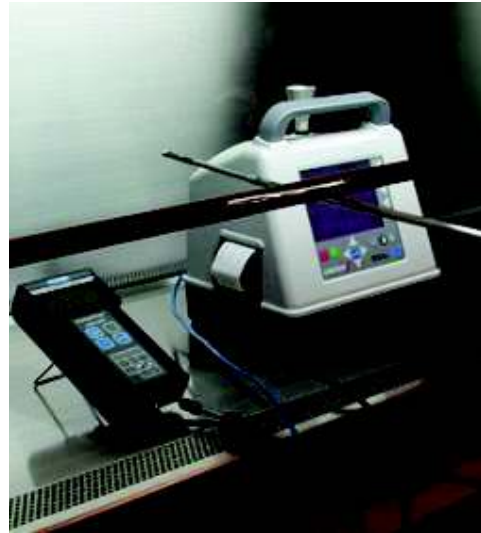
Figura 11 B: Medición de velocidad con anemómetro de hilo caliente Alnor dentro de un equipo de seguridad biológica con conteo de partícula con contador de rayo láser PMS
