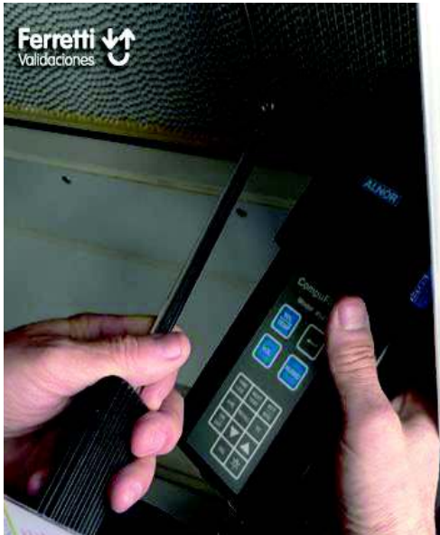
Figura 11 A: Medición de velocidad de aire con anemómetro de hilo caliente
