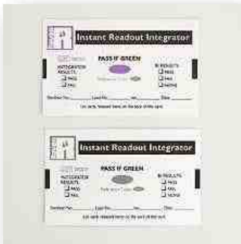
Figura 8. Integrador químico Clase 5 de resultado inmediato. Si la esterilización es aceptable el color cambia de rosa a verde.
