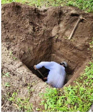
Fotografía 2. Conformación de Calicata para posterior extracción de muestra
