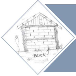
**Quiosco y área de servicios.** Los materiales a implementar son mampostería en muros y de bambú la estructura de los techos, los caminamiento serán de adoquín decorativo.
