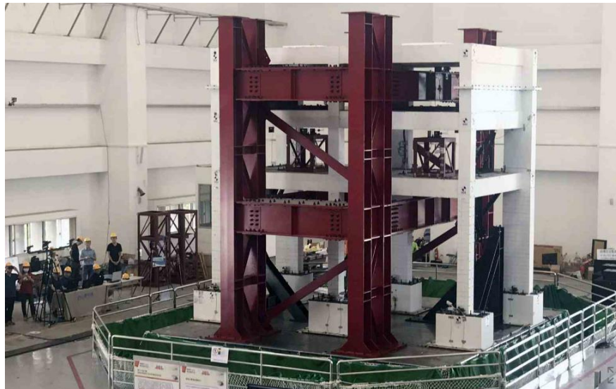
Ilustración 50. Elemento estructural que será evaluado bajo cargas sísmicas simuladas con 6 grados de libertad, las personas usan cascos de protección.
