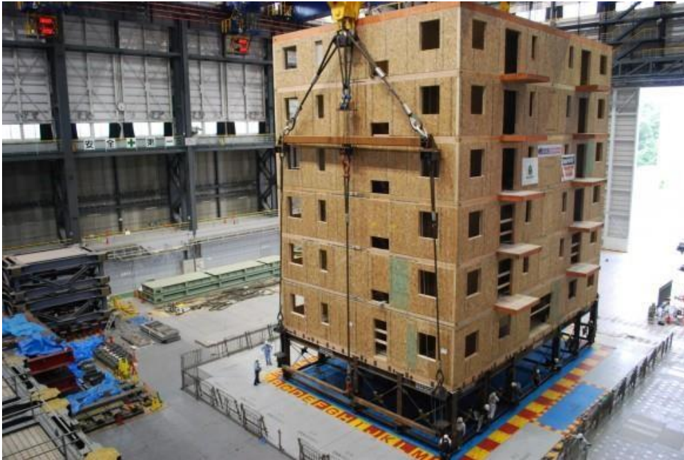
Ilustración 8. Prueba de torre de condominios de siete pisos en mesa vibratoria.
