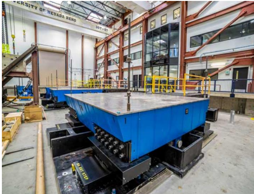
Ilustración 5. Mesa vibratoria en el Centro de investigación de terremotos en ingeniería civil de la Universidad de Nevada Reno, Estados Unidos.
