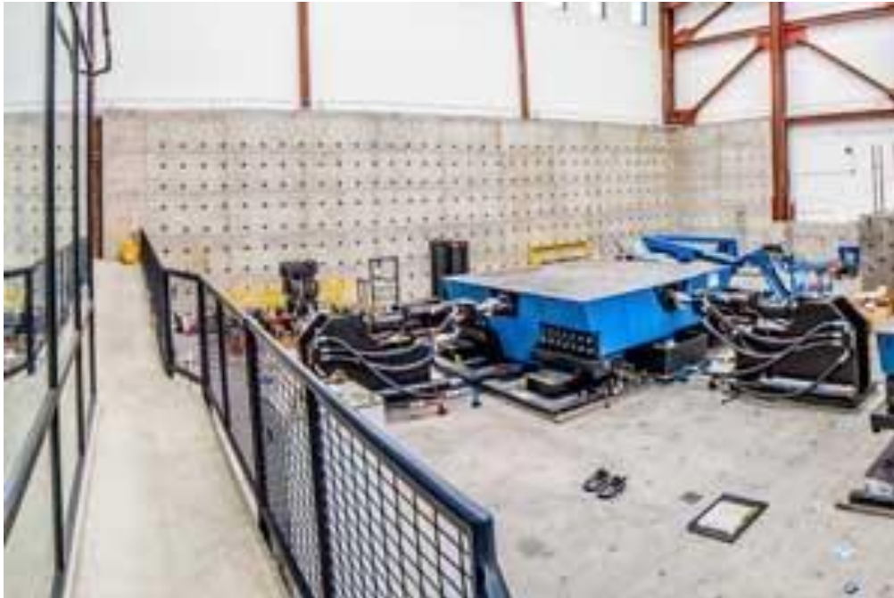
Ilustración 7. Muro de reacción del Centro de investigación de terremotos en ingeniería civil de la Universidad de Nevada Reno, Estados Unidos.
