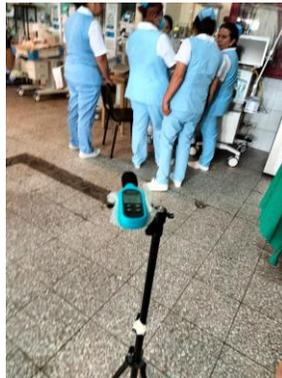
***Ilustración 21 - Medición de Niveles de decibeles de uso de equipo de succión (aspirador) en Unidad de Cuidados Intensivo Neonatal.***
