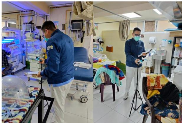
***Ilustración 3 - Midiendo Niveles de decibeles del burbujeo del vaso humidificador de oxígeno en Labor y Partos.***
