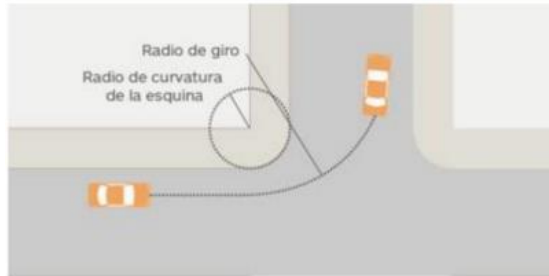
Ilustración 44 - Radio de Giro en calles. Fuente: Manual de diseño vial para ciudades en México
