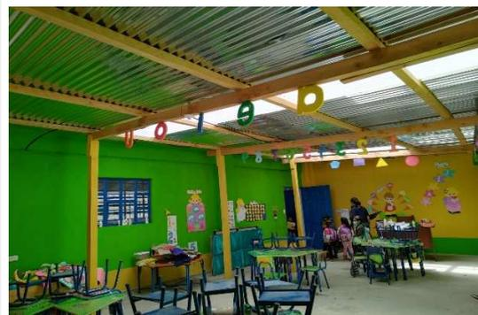
La ventilación dentro de los ambientes es cruzada, las aulas tienen ventanas de ambos lados sin embargo, la ventilación e iluminación se ve interrumpida por el techo que existe en el pasillo que no deja que se aproveche al máximo la luz natural durante el día.
